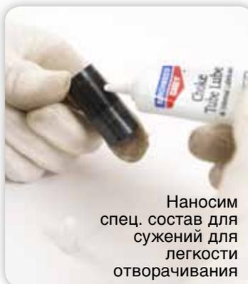
Наносим спец. состав для сужений для легкости отворачивания
